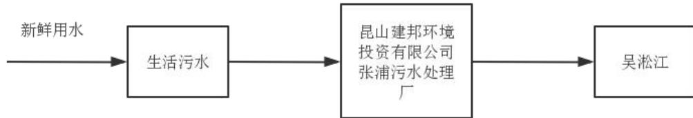
图 4-1 废水处理及排放流程
