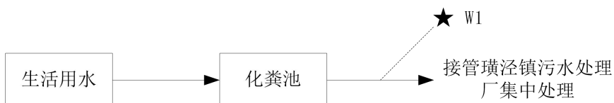
图 4-1 生活污水处理及排放流程图
