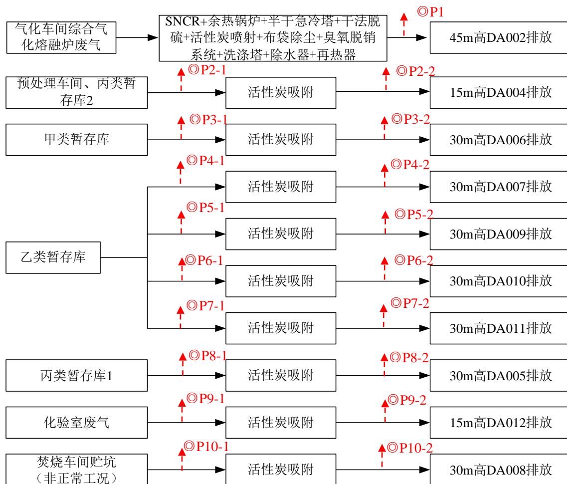
图 4-5 废气处理工艺流程（附“◎”废气监测点位）
