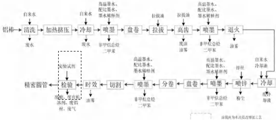
图 3-1 精密圆管生产工艺流程和产污环节图
