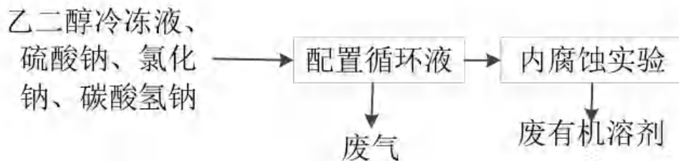
图 3-3 内腐蚀实验工艺流程图
