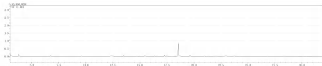
图 9-13 样品的 SVOCs 的总离子流图 (TIC) (含内标、替代物及柱流失硅氧峰)
