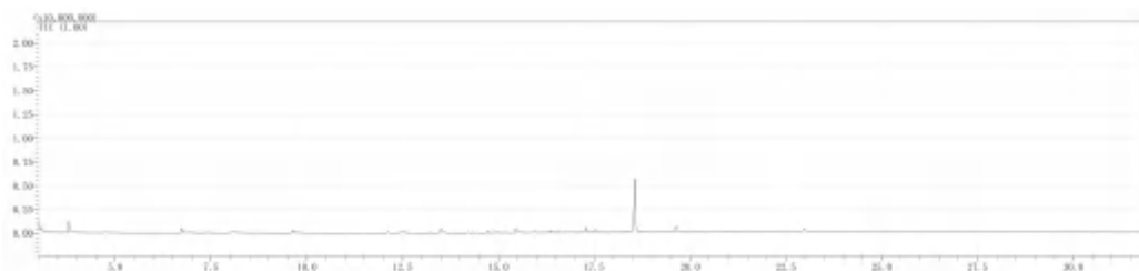
图 9-9 样品的 SVOCs 的总离子流图 (TIC) (含内标、替代物及柱流失硅氧峰)
