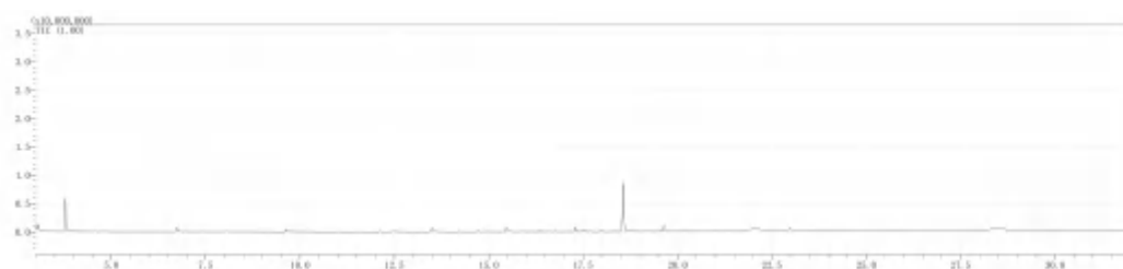
图 9-8 空白的 SVOCs 总离子流图 (TIC) (含内标、替代物及柱流失硅氧峰)
