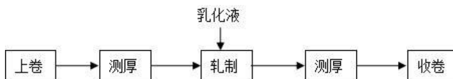
图 4.1-2 冷轧机组生产工艺
