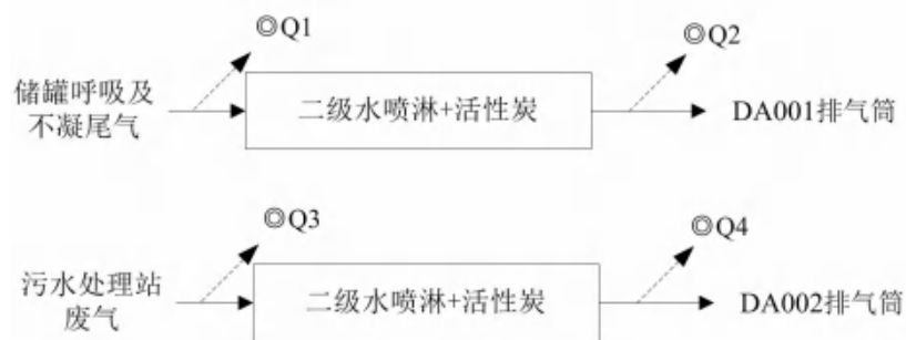
图 4-5 废气处理及排放流程（附“①”废气监测点位示意图）
