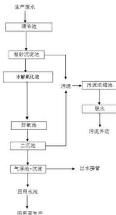
图 4-1 废水处理工艺流程图
