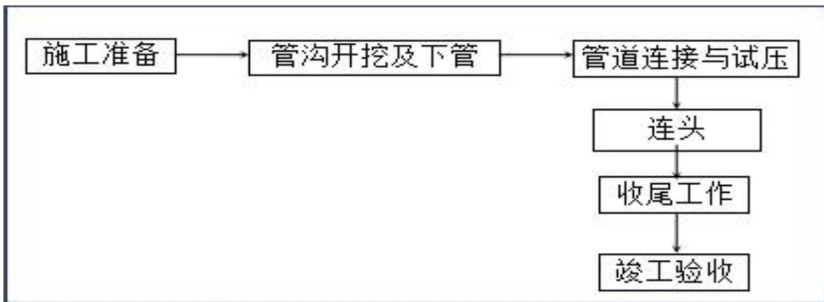
图 4-3 施工期工艺流程示意图
