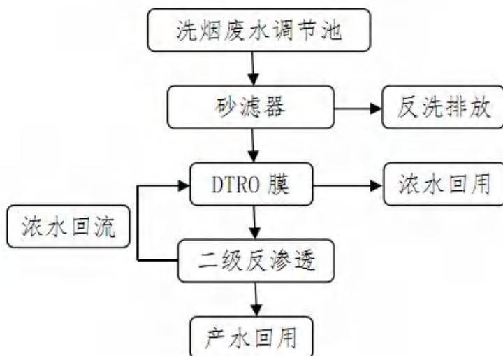
图 4-3 洗烟水处理系统废水处理工艺流程图
