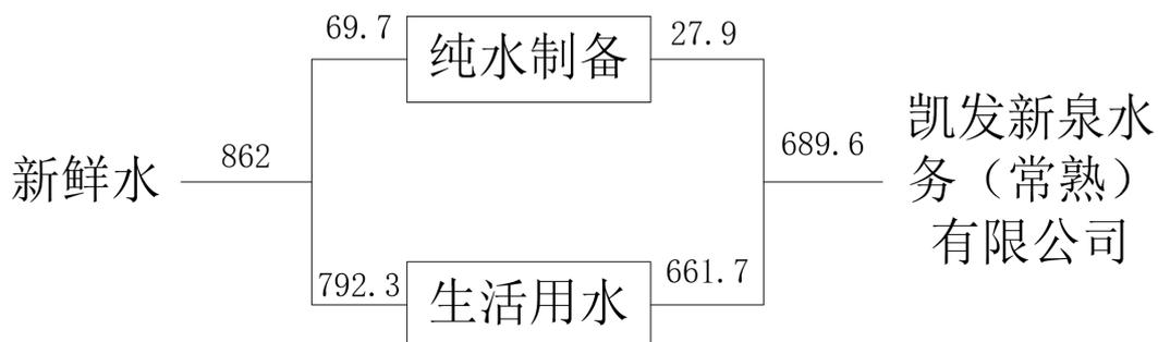
图 2-1 10-2 幢水平衡图 (t/a)
