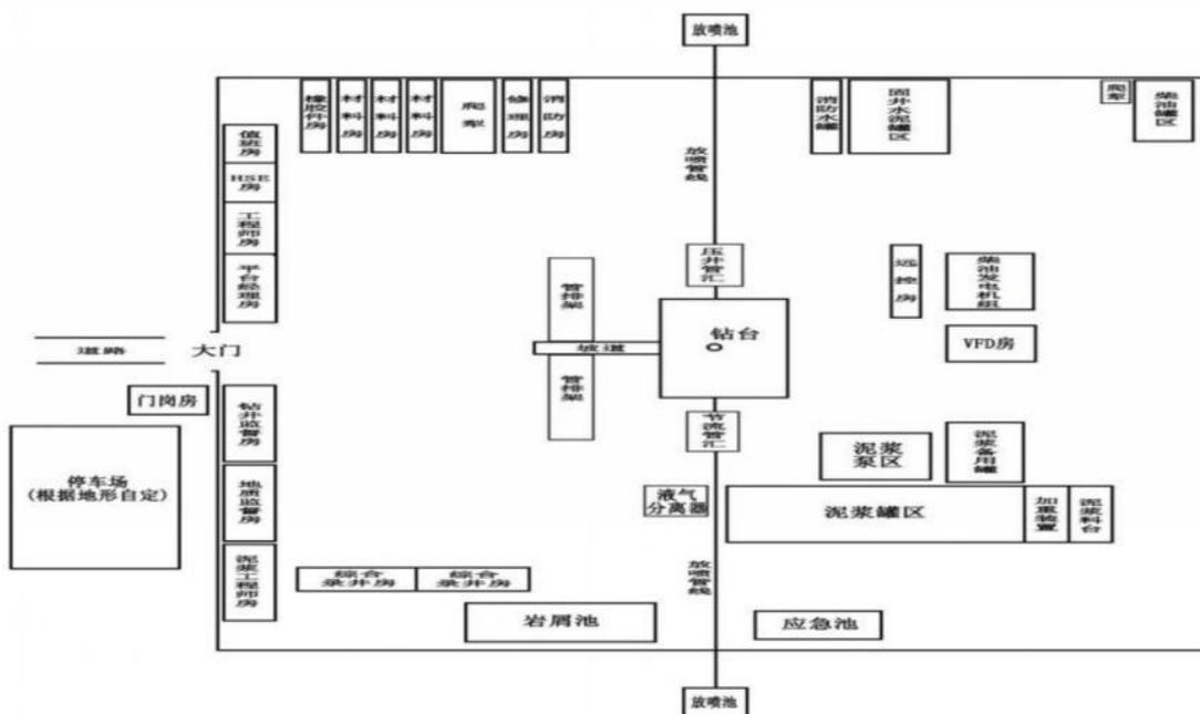
图 4-3 钻井期井场平面布置示意图
