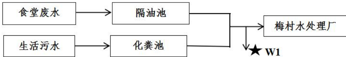
图 4-1 废水处理及排放流程（附“★”废水监测点位）
