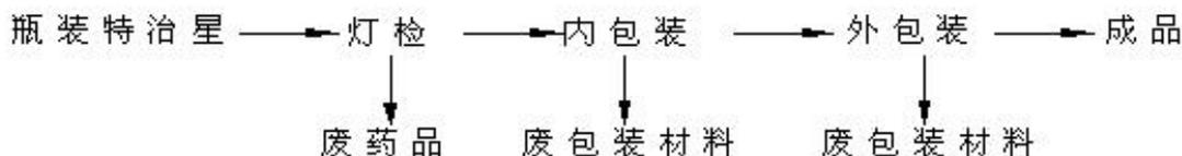
图 4-4 特治星生产工艺流程图
