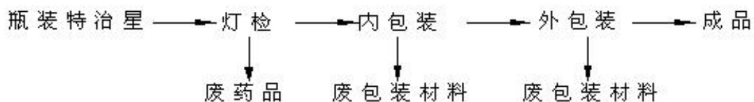
图 2-7 特治星生产工艺流程图
