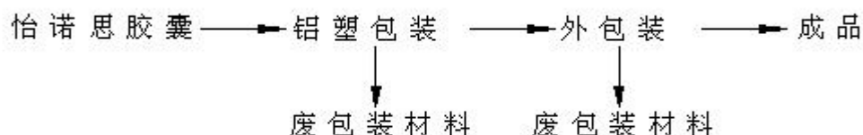
图 2-6 怡诺思胶囊生产工艺流程图
