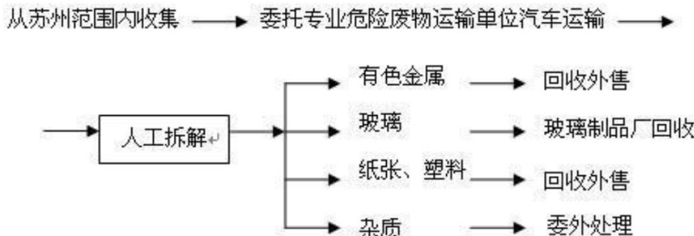
图 4.1-2 废电子元器件处理工艺流程图
