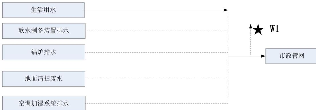
图 4-1 废水流程图 (★表示废水监测点位)
