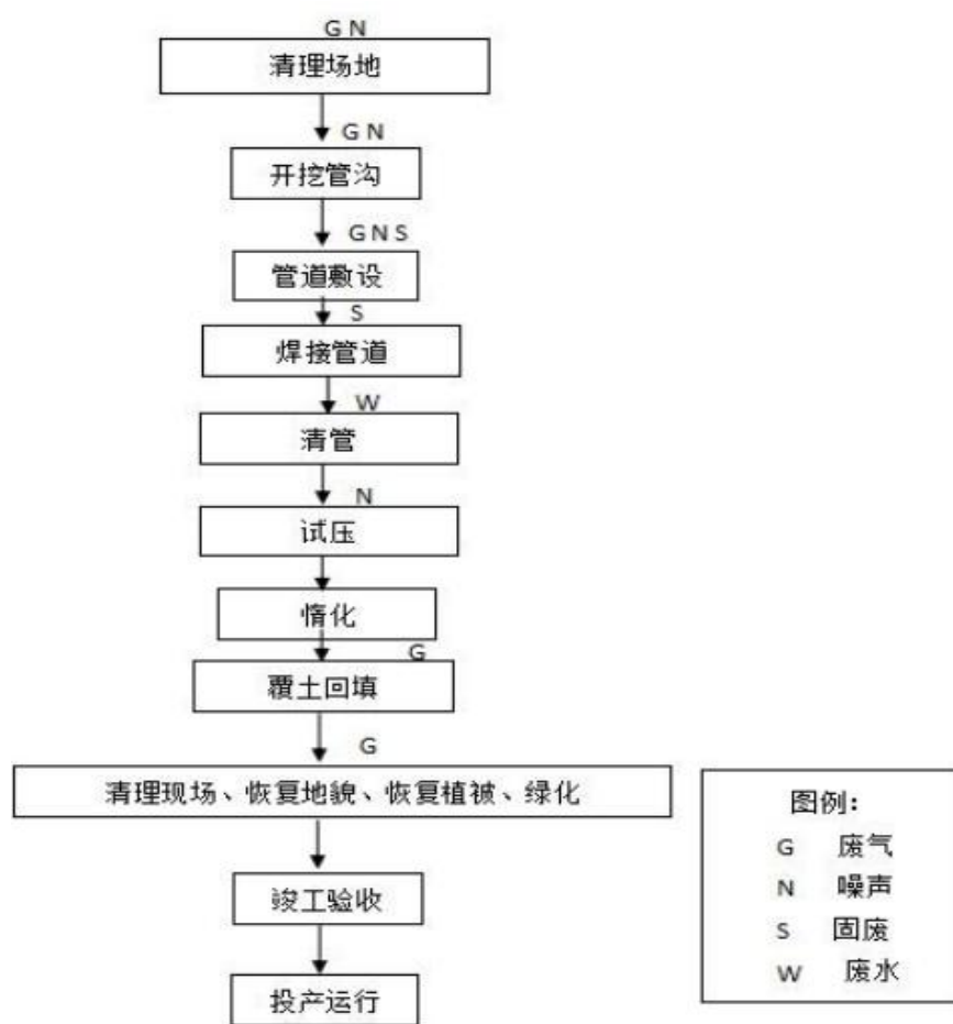
图 2-3 管线施工工艺流程及产污位置示意图
