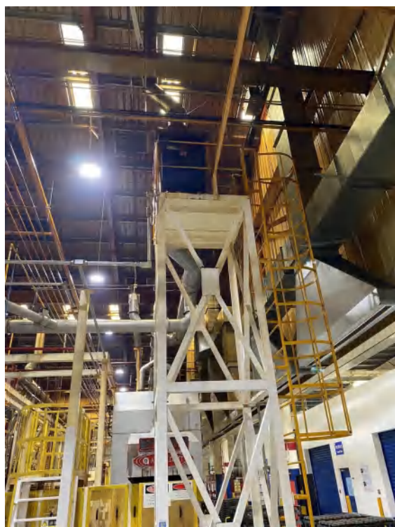
后清洗回火油雾过滤器
