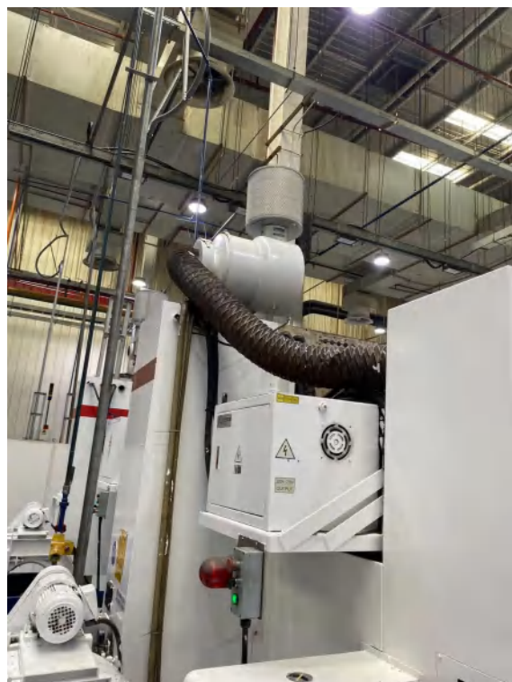
机加工设备自带油雾过滤器
