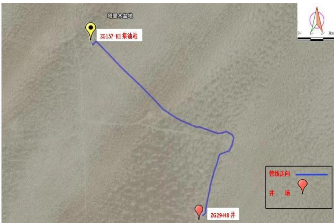
图 2-2 ZG29-H8 井管线走向图
