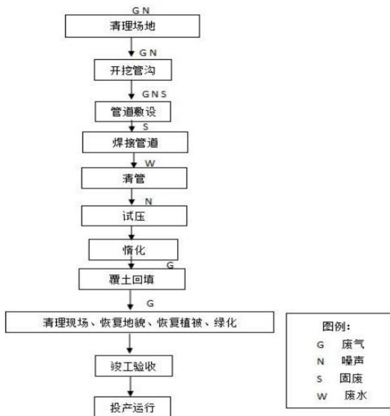
图 2-1 管线施工工艺流程及产污位置示意图
