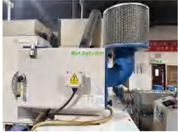
金加工工序自带油雾分离器
