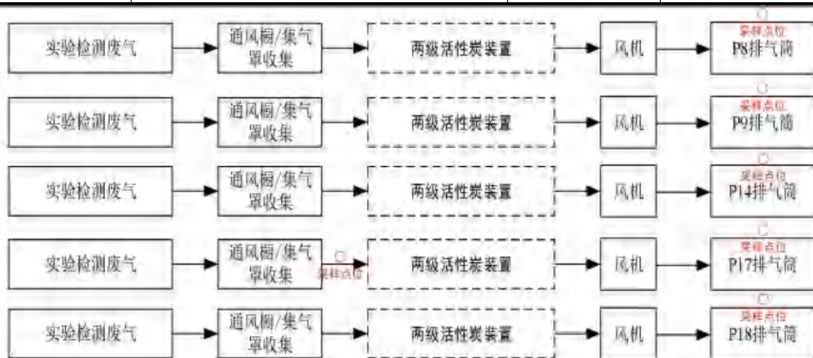
图 4-3 废气处理工艺流程图 (○表示监测点位)
