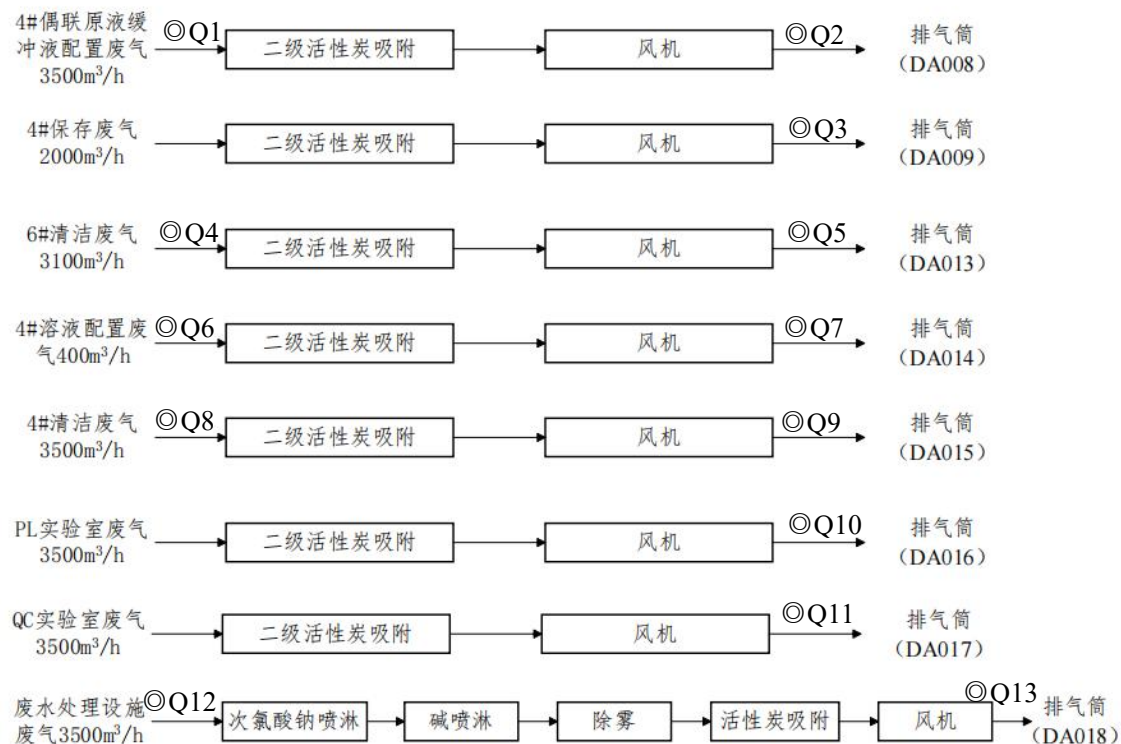
图4-5 废气处理设施工艺图（附“◎”废气监测点位）
