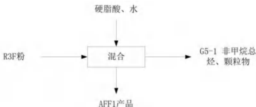
图 4.1-5 AFF1 阴离子沥青乳化剂生产线工艺流程及产污环节图
