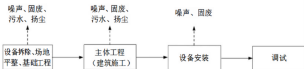
图 2-3 施工期工艺流程及产污环节示意图
