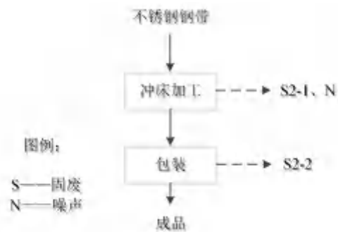
图 3-2 弹簧卡箍生产工艺流程图及产污环节
